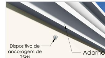
**2ª ETAPA:** Após o tempo de espera para a cura conforme discriminado no manual do fabricante, rosqueie o dispositivo de ancoragem.
